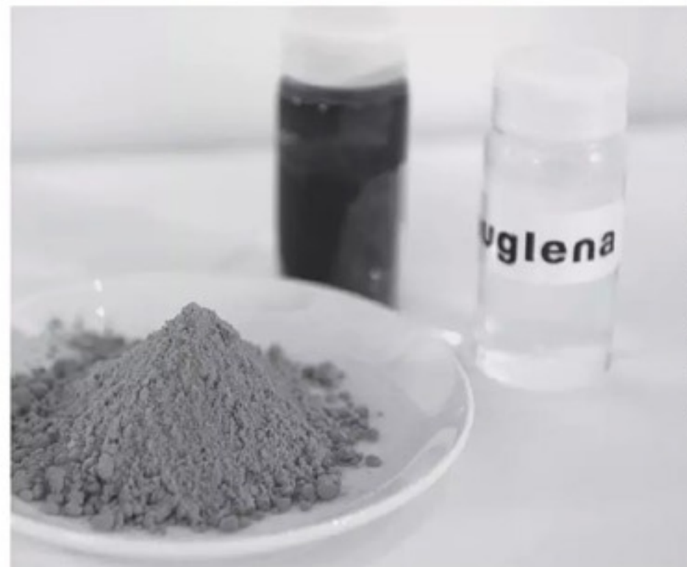
手前がミドリムシを乾燥させ粉状にしたもの。右奥の透明な液体が、2020年の実用化に向けて踏み出す、ミドリムシ由来のジェット燃料だ
